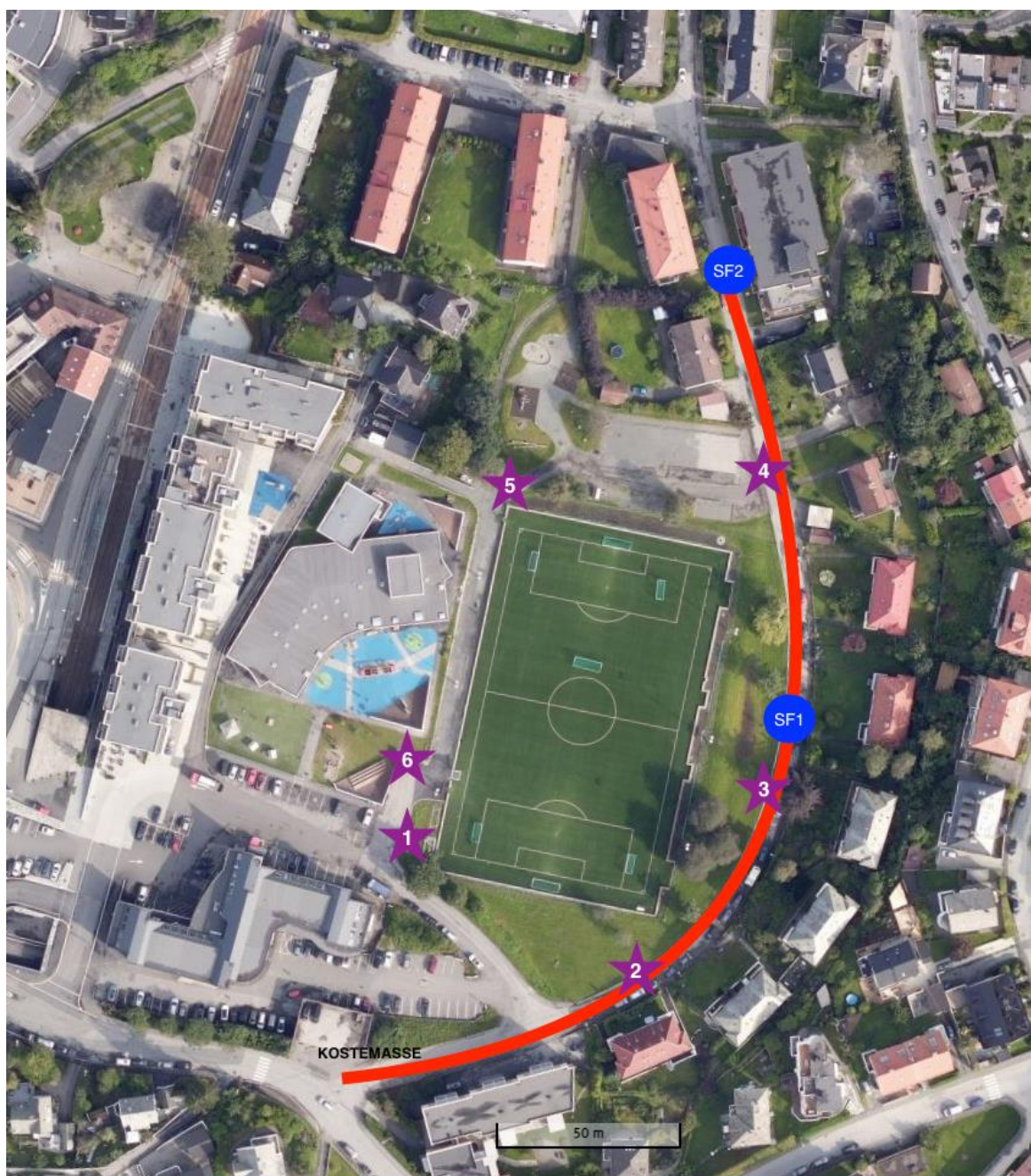
Figur 3.7. Kunstgressbanen på Kronstad (Rautjernbanen) med prøvepunktene rundt banen markert: Lilla stjerner = sedimentprøver langs gangvei, blå sirkler = sandfang, rød linje = distansen kostebil kjørte for innsamling av kostemassen (grønne rektangler = utganger fra banen, utstyrt med rist og koster til skoene). Flyfoto: Kartverket
