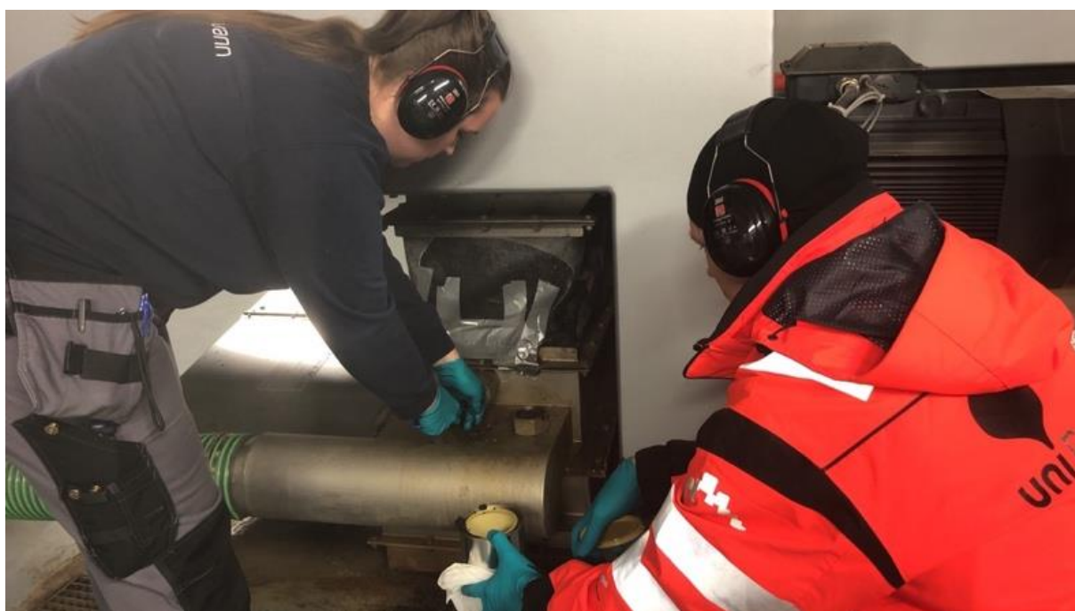
Figur 3.14. Prøvetakning fra sentrifugen ved Holen avløpsrensseanlegg i samarbeid med kommunens ansatte. Foto: NORCE, Marte Haave
