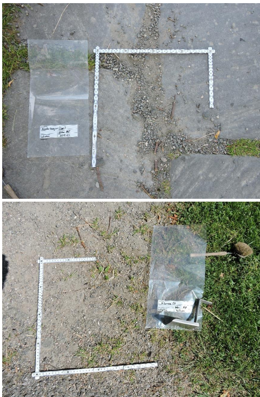
Figur 3.8. Illustrasjon av prøvetaking ved groper og naturlige oppsamlingspunkter i underlaget der mikroplast forventes å avsettes. Foto: NORCE
