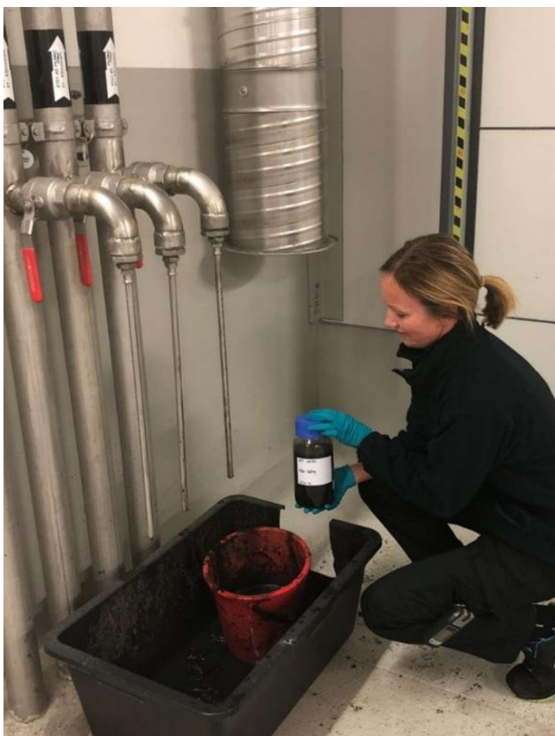
Figur 3.15. Prøvetakning av bioslam og biorest etter biogassproduksjon i Råtnetankene ble utført av ansatte ved Rådalen Biogassanlegg. Foto: NORCE, Marte Haave
